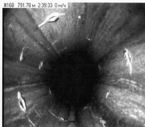
Кумулятивная перфорация в эксплуатационной колонне
