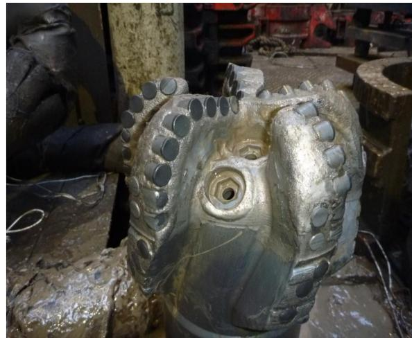
Рисунок 6. Состояние долота БИТ 220,7 ВТ 513 УСВ.32-01 № 16767 после отработки на скважине № 102 Термокарстового ГКМ
